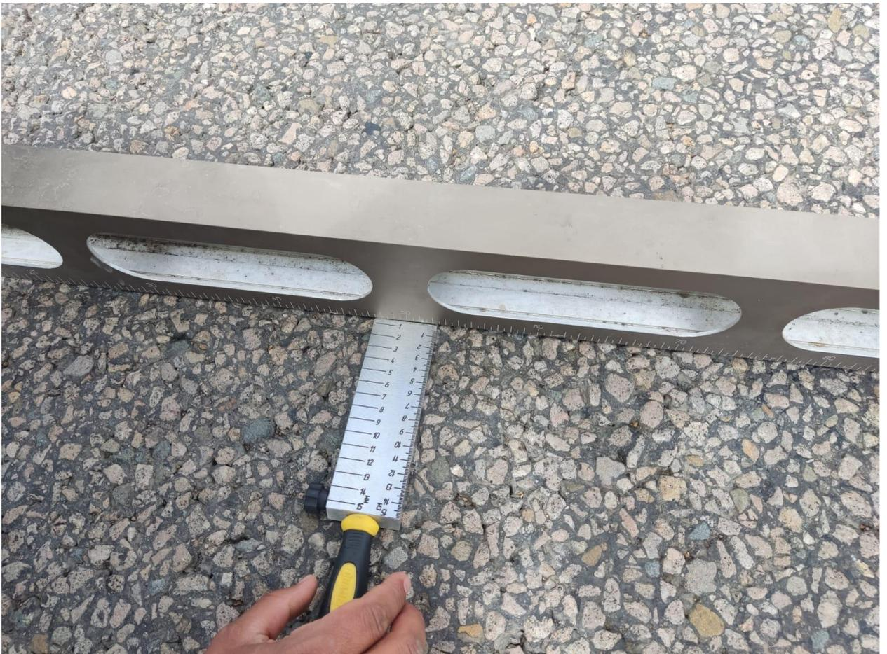
СП "КАЗГЕРСТРОЙ": ПК 65+00 (РАЗВЯЗКА Г КОСШЫ) КОЛЕЙНОСТЬ ДО 1ММ
